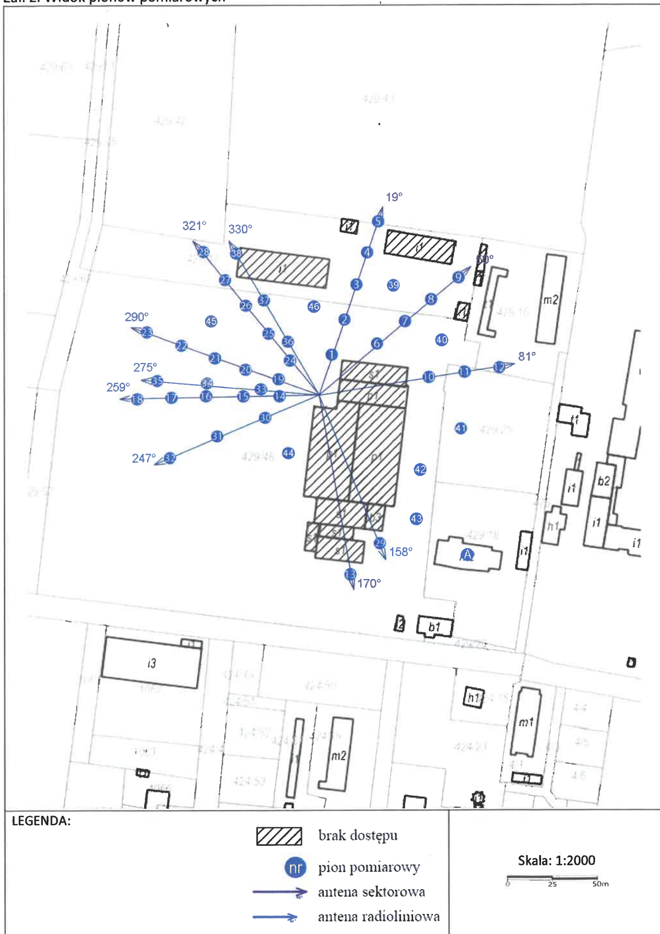
Załącznik 2. Widok pionów pomiarowych
